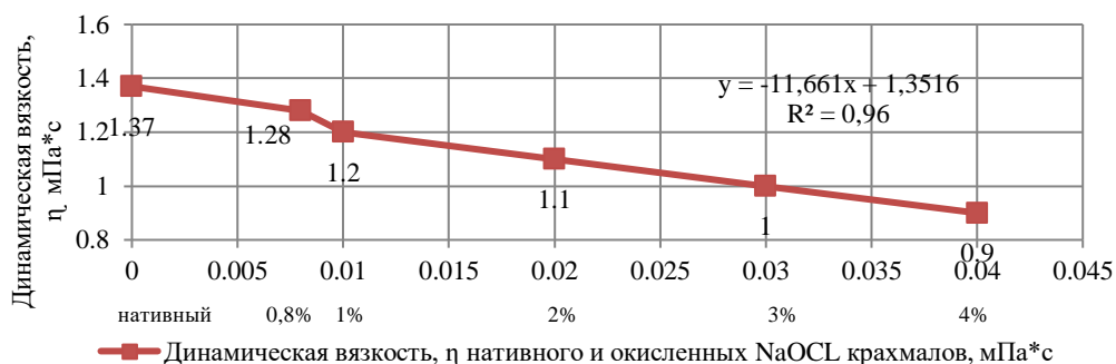
Рисунок 2 - Динамическая вязкость крахмальных суспензий нативного и окисленного NaOCl крахмалов в зависимости от концентрации окислителя
